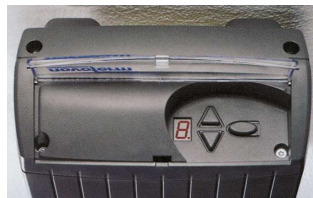
Programmierung über 3 Knöpfe mit 7-Segment-Anzeige
